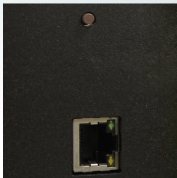
內建紙張自動偵測定位鍵及 Ethernet連接埠
