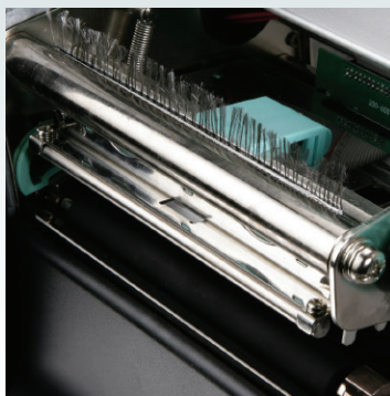
印字頭模組化設計 可輕鬆拆卸及換裝
